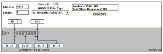
Figure 100. 32-Bit Bit-Mapped Parameter Mapping
