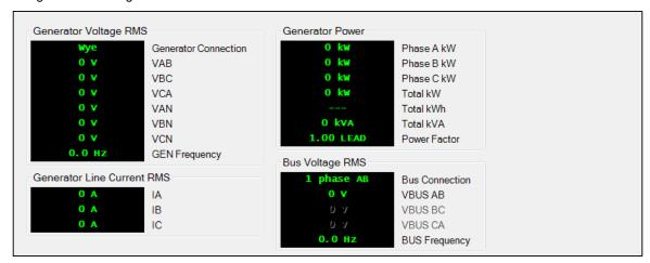
Figure 28. Metering Explorer, Generator Screen
