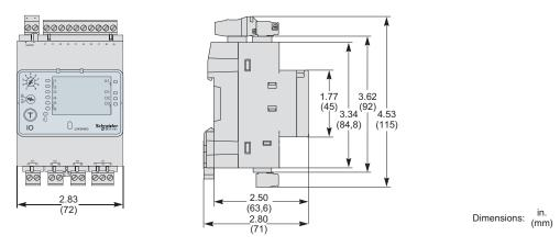
Figure 63: IFM Modbus-SL Interface
