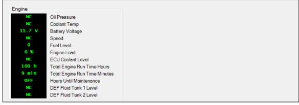
Figure 27. Metering Explorer, Engine Screen
